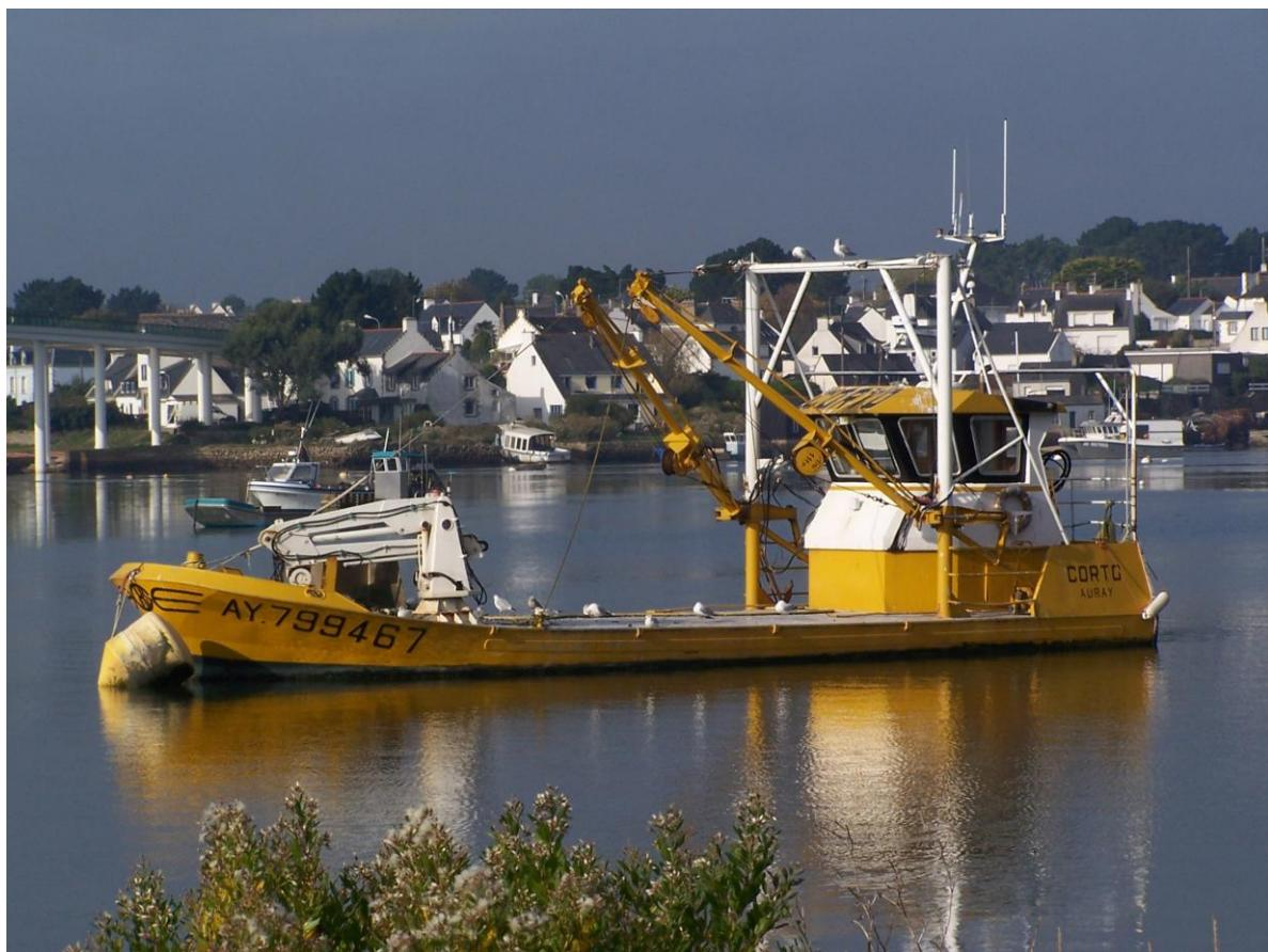
Au départ de ces opérations, l'utilisation d'un chalut modifié pour permettre le pompage des algues était préconisée. Cette méthode qui entraînait des captures accidentielles de poissons a été peu à peu remplacée par une sorte de râteau qui piège les algues. Cette technique expérimentée cette année a l'avantage d'épargner la faune. Les rendements peuvent atteindre 10 à 15 tonnes par jour ce qui a représenté un total de 65 tonnes prélevées en baie de Douarnenez en 2013.
