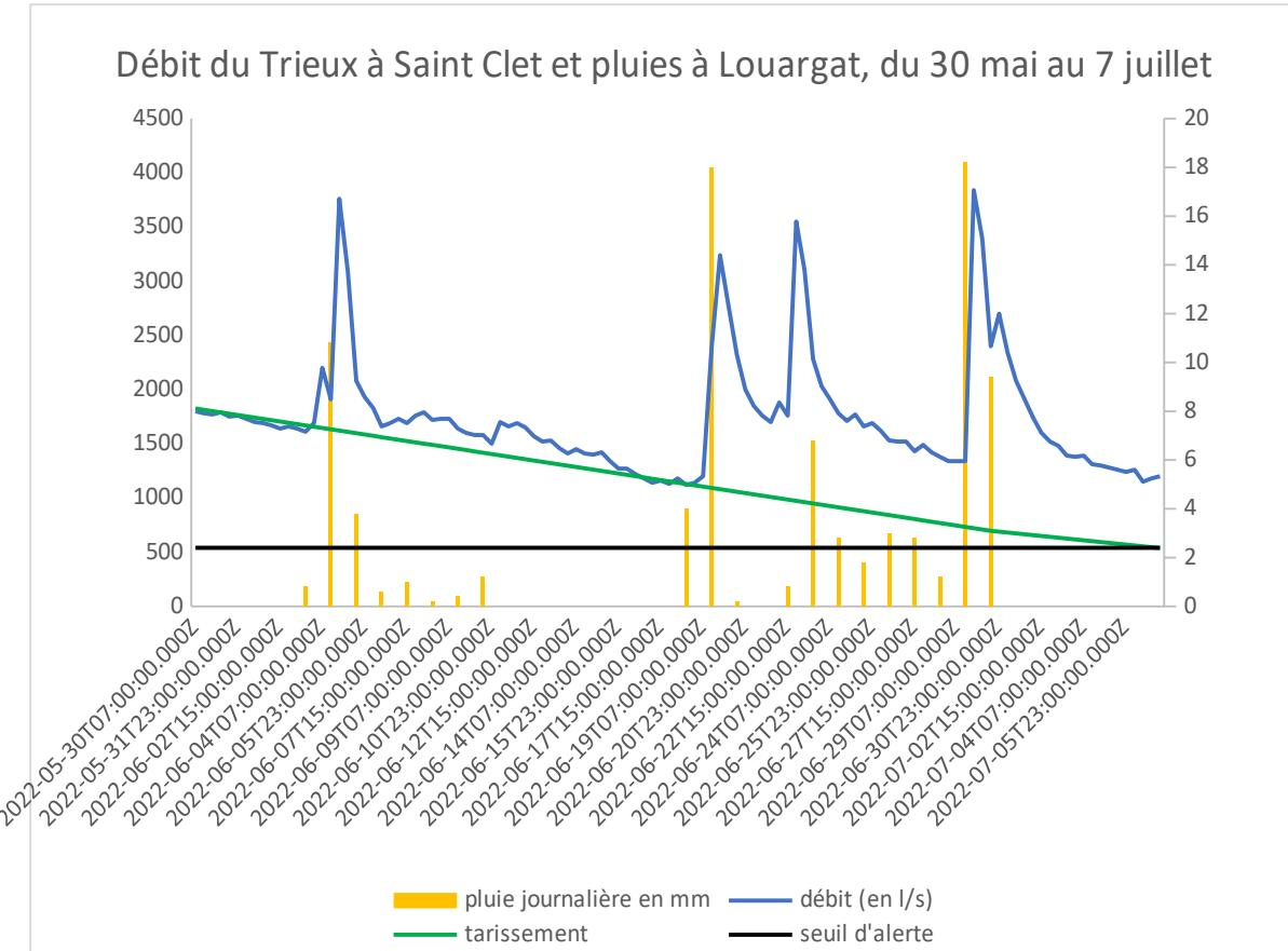
L'échelle de gauche est celle des débits, en litres par seconde, l'échelle de droite celle des pluies, en mm par jour.
